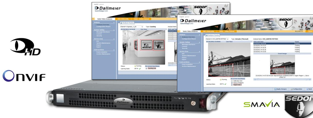
Устройство **DVS 2200 IPS** представляет собой высококлассный сервер видеоаналитики системы SEDOR®, предназначенный для анализа до 12 видео потоков и записи до 24 видео потоков, передаваемых по IP-каналам.
